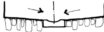
schemi per lo scolo delle acque nei percorsi esterni
